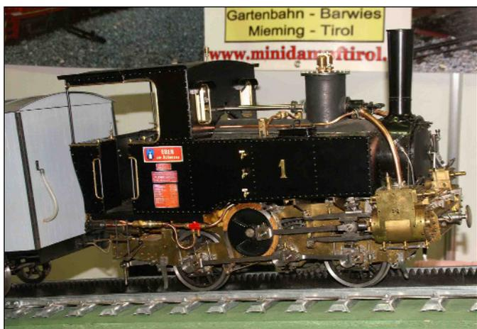
Achenseebahn-Zahnradlok Eben von Günther Eckl, 5 Jahre Bauzeit mit ca. 5000 Arbeitsstunden verschlang diese Lok. Der Güter-Begleitwagen enthält einen Wassertank. Noch in diesem Jahr sind die ersten Probefahrten auf der Mini-Dampf-Tirol in Barwies vorgesehen.
