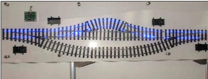
Weichen-Demotafel beim Herforder Lokschuppen. Anzeige der Weichenstellung mittels LED's. Unten: HSB-Köf II vor und nach der Lackierung
