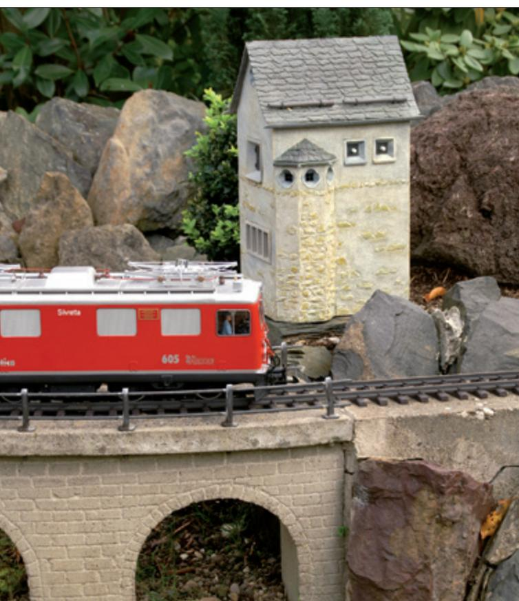
*Von Modellbau Kotsch stammt dieses urige Traföhäuschen. Es ist aus Resin im exakten Maßstab von 1:22,5 dem Original-Trafohaus „Susch“ an der RhB-Strecke Samedan – Scuol nachgebaut.*
