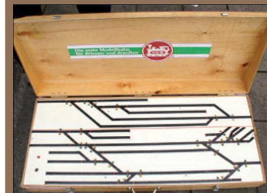
*An Fahrtagen der jährlich von April/Mai bis Oktober betriebenen Außenanlage wird dieses in einen Holzkasten integrierte und transportable Gleisbildstellpult auf der Terrasse mit einem als Fernmeldekasten getarnten Anschlusskasten verbunden, in dem auf professionellen Steckverbindungen sämtliche elektrischen Leitungen der Anlage aufliegen. Natürlich alles Eigenbauten „Made by Brehm“.*
